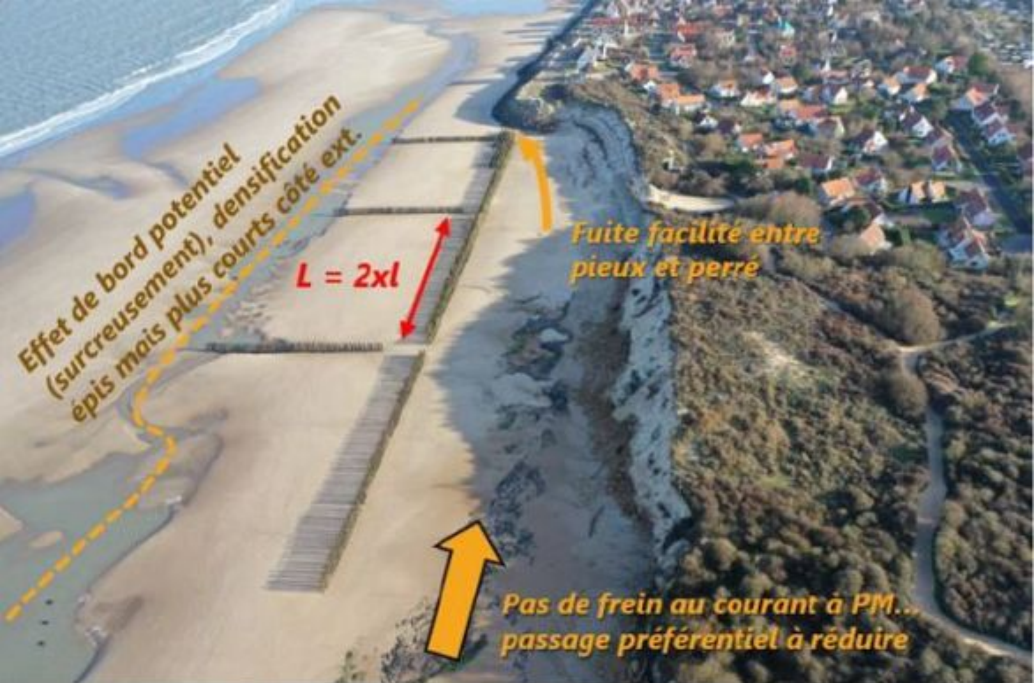
Figure 53 : Analyse du dispositif pieux bois existant
