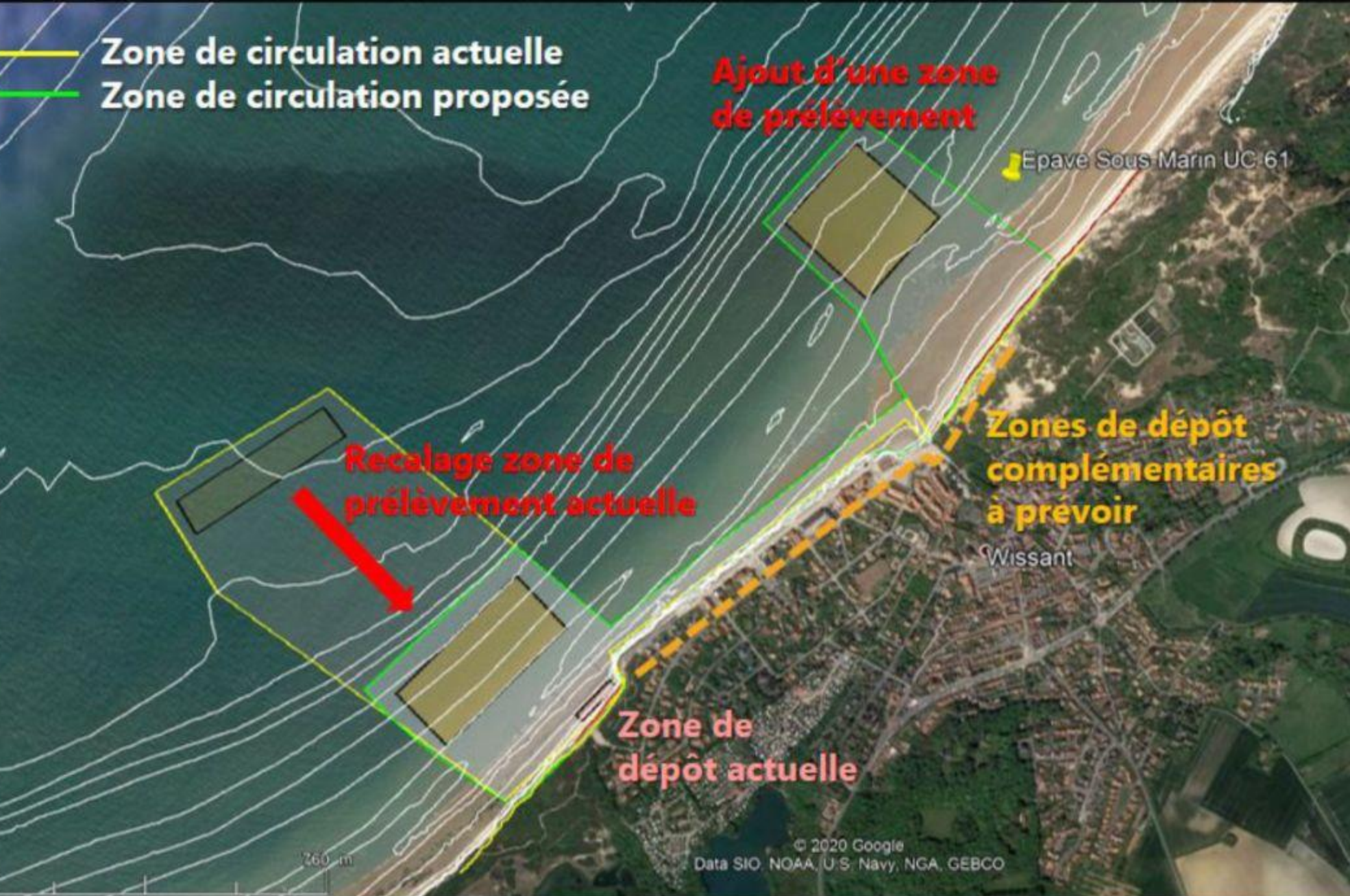
Figure 72 : Adaptations proposées pour les opérations de remontées de sable actuelles (AOT 2017-2022)
