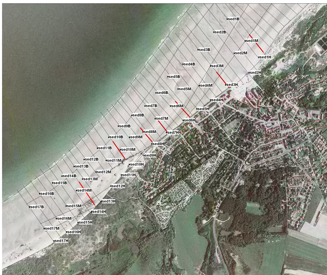
Figure 8: plan de position des points de prélèvements
