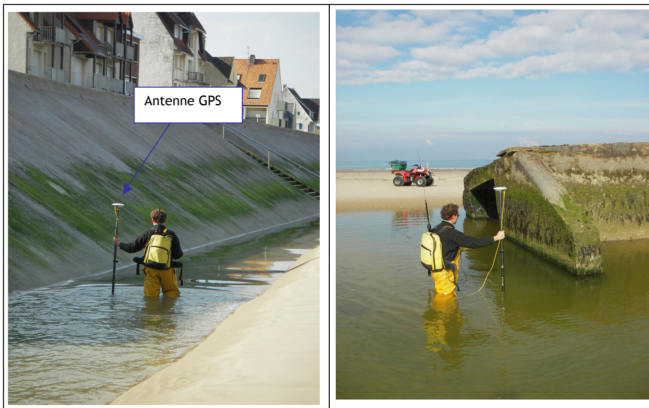
Figure 4: mesure à pied au niveau des ouvrages
