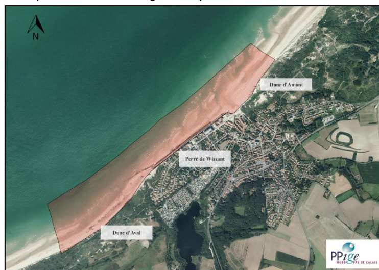
Figure 3: Périmètre de réensablement défini au CCTP
