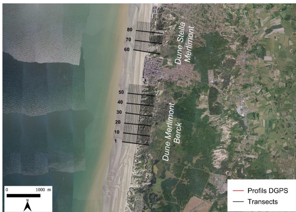
Figure V-3 : localisation des transects utilisés pour le calcul des bilans volumétriques LiDAR pour le site de Merlimont.
